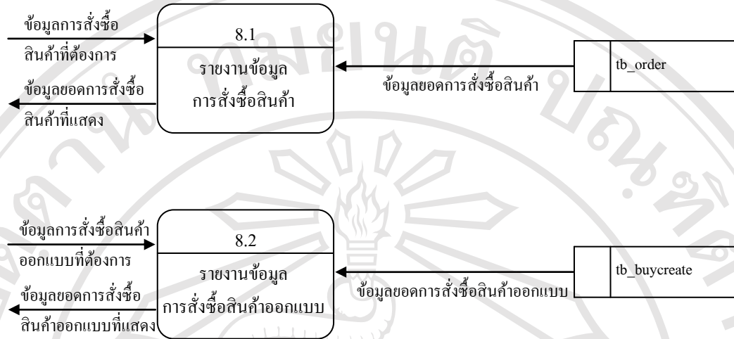
รูป 3.10 แสดงแผนภาพการไหลข้อมูลระดับที่ 1 กระบวนการ 8.0 ออกรายงานและข้อมูลสารสนเทศ
