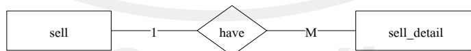
รูป 4.25 แสดงความสัมพันธ์ระหว่าง ตารางการขาย และ ตารางรายละเอียดการขาย
