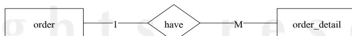
รูป 4.8 แสดงความสัมพันธ์ระหว่าง ตารางการสั่งซื้อ และ ตารางรายละเอียดการสั่งซื้อ
