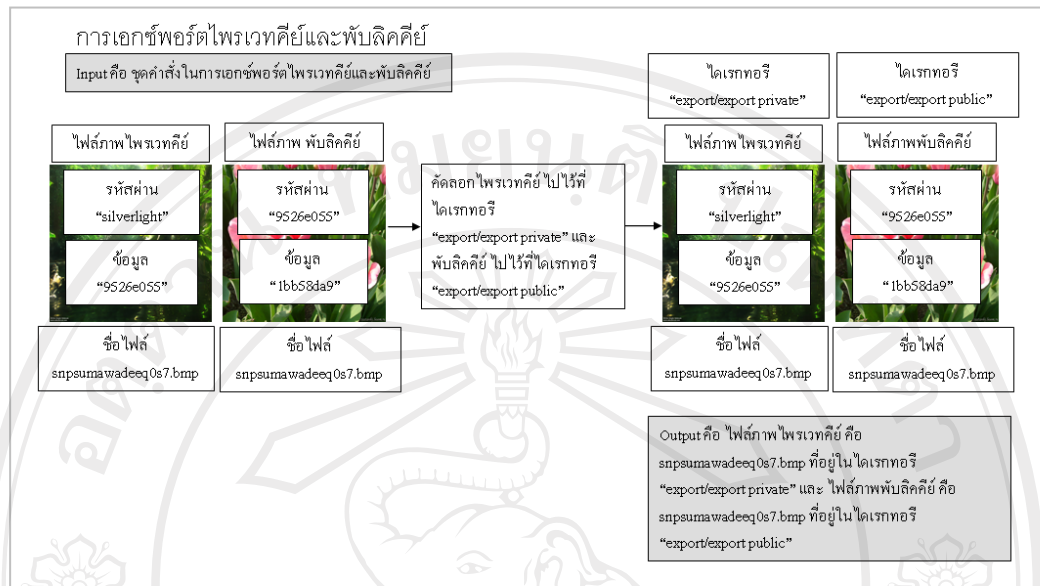
รูป 3.24 แสดงขั้นตอนการทำงานของ การเอกซ์พอร์ตไพรเวทีย์และพับลิคีย์
