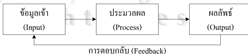
รูป 2.1 แสดงกิจกรรมพื้นฐานของระบบสารสนเทศ
