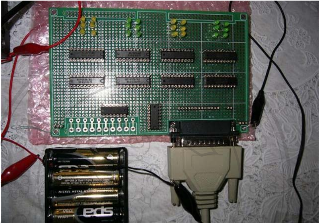
รูปที่ ค.2 แสดงรูปถ่ายอุปกรณ์แสดงผลอักษรเบรลล์ผ่านทาง LED
