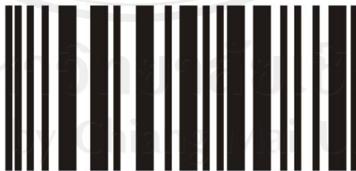
รูป 2.1 บาร์โค้ด 1 มิติ หรือ บาร์โค้ดแบบแท่ง ( http://www.tigerlabel.com )
