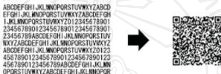
รูปที่ 2.1 แสดงตัวอย่างการบรรจุข้อมูลของ Alphanumeric จำนวน 300 ตัว ไว้ในบาร์โค้ดสองมิติ (Two-Dimension Barcode) เพียง 1 ภาพ
