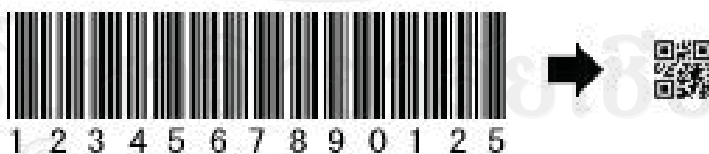
รูปที่ 2.2 แสดงเปรียบเทียบการบรรจุข้อมูลระหว่างบาร์โค้ดแบบธรรมดาและบาร์โค้ดสองมิติ
