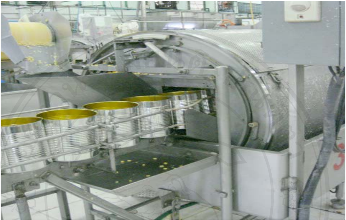
ภาพ 13 เครื่องบรรจุข้าวโพดขนาด 108 ออนซ์
