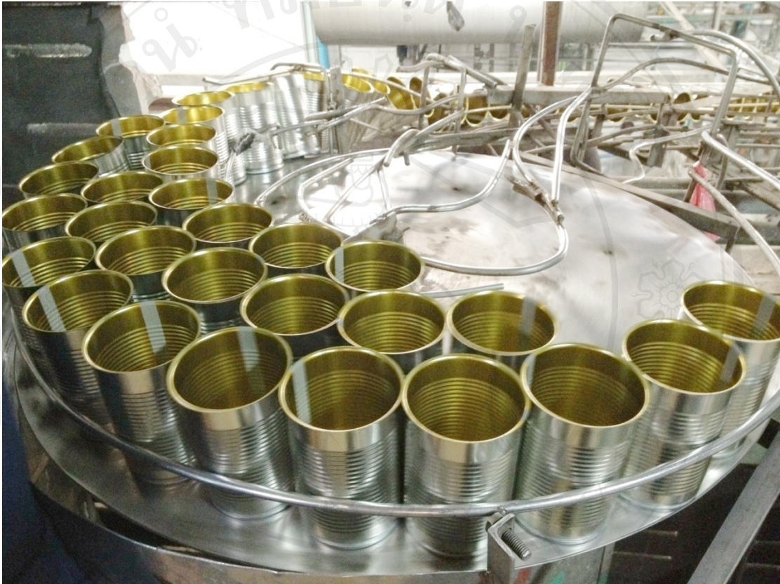
ภาพ 11 งานหมุนลำเลียงกระป๋องเพื่อเข้าสู่ขั้นตอนการบรรจุ
