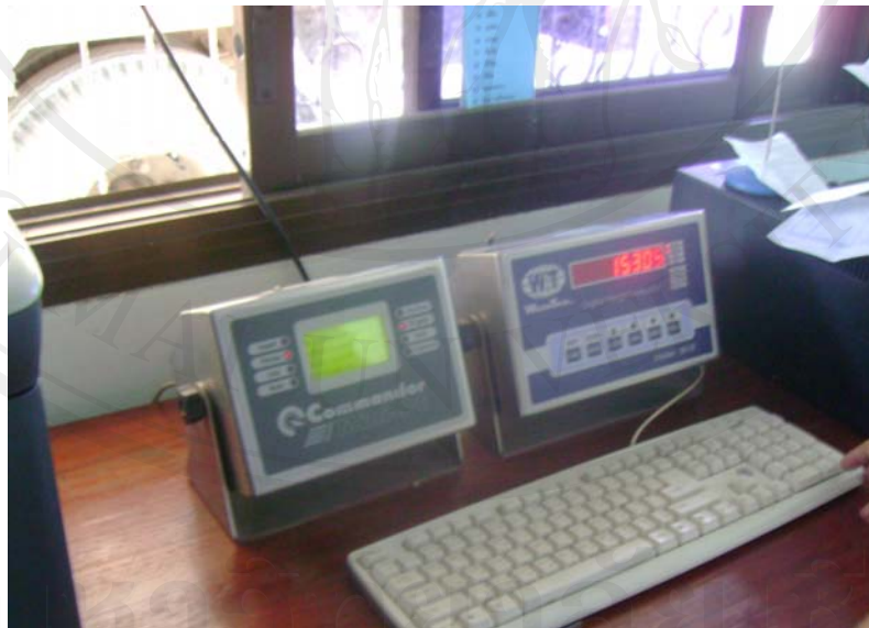
ภาพที่ 4.13 จอแสดงผลเครื่องชั่ง (Weight Indicator)
