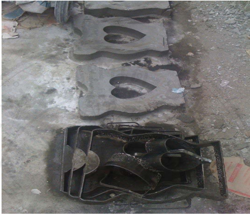
ภาพที่ 35 การหล่อขาเก้าอี้ม้าหินอ่อนแบบมีไม้พนักพิง ขั้นตอนที่ 3 นำขาเก้าอี้ที่แห้งแล้วถอดออกจากแม่พิมพ์หลังจากนั้นผสมปูนขาวกับน้ำ เล็กน้อยเพื่อนำมาทาสีขาวให้ทั่วขาโต๊ะเพื่อให้เกิดความสวยงาม ดังภาพที่ 36
