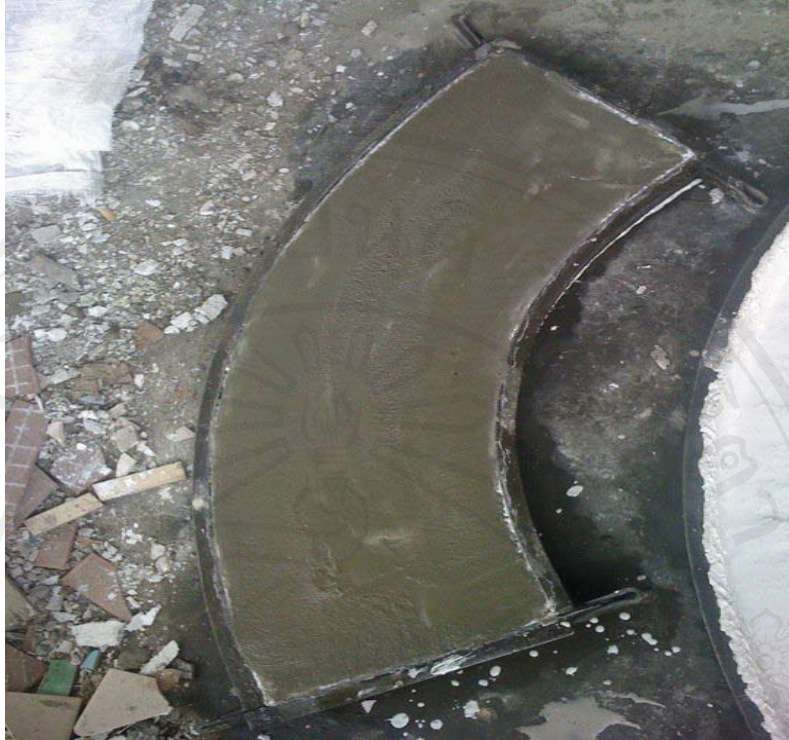
ภาพที่ 42 การเทปูนผสมทรายละเอียดและน้ำ เกลี่ยให้ทั่ว ชั้นตอนที่ 9 รอให้ปูนขาวแห้งจากนั้นนำขาเก้าอี้ที่หล่อไว้ก่อนหน้านี้มาเชื่อมต่อกับฐาน ของเก้าอี้ในขณะที่ฐานเก้าอี้ยังไม่แห้ง โดยใช้เหล็กเส้นเป็นตัวยึด ดังภาพที่ 43 และ ภาพที่ 44
