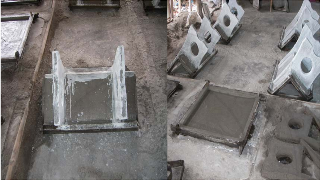
ภาพที่ 44 การเชื่อมต่อฐานเก้าอี้และขาเก้าอี้แบบมีพนักพิง
