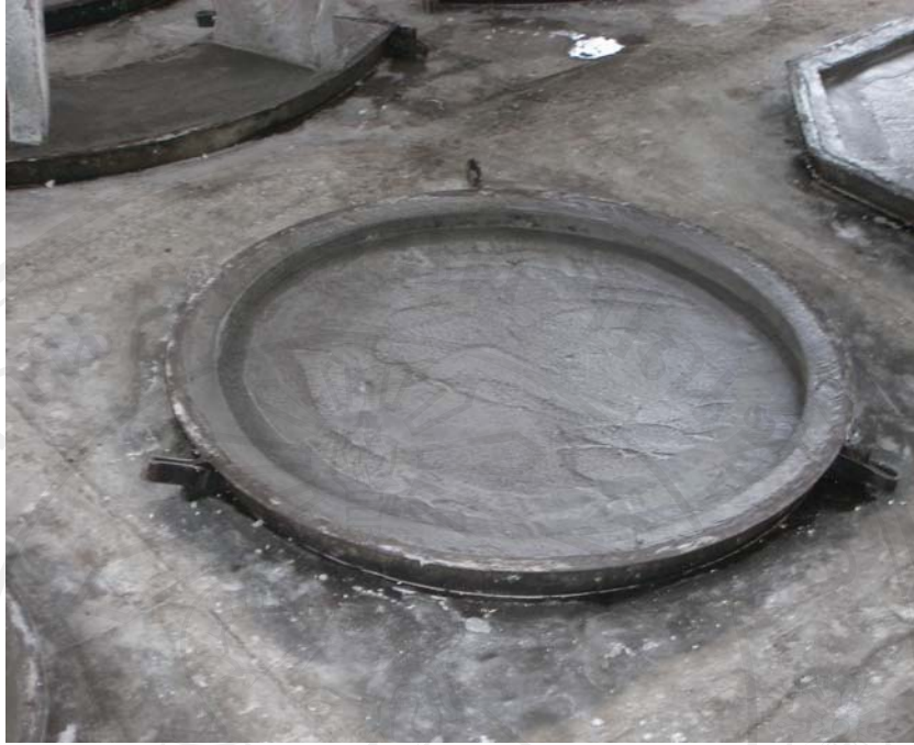
ภาพที่ 28 การนำปูนดำ,ทรายละเอียดและน้ำที่ผสมกันมาเทในแม่พิมพ์ ชั้นตอนที่ 7 หล่อในส่วนของขาโต๊ะ โดยจะต้องชุบน้ำมันก๊าดให้ทั่วแบบพิมพ์เพื่อป้องกัน การยึดติดของปูน จากนั้นผสมส่วนผสมคือ ปูนดำ ทรายละเอียดและน้ำ เทลงไปในแบบพิมพ์ขาโต๊ะที่ เตรียมไว้ รอให้แห้งสนิทแล้วจึงนำออกจากแบบพิมพ์ ดังภาพที่ 29
