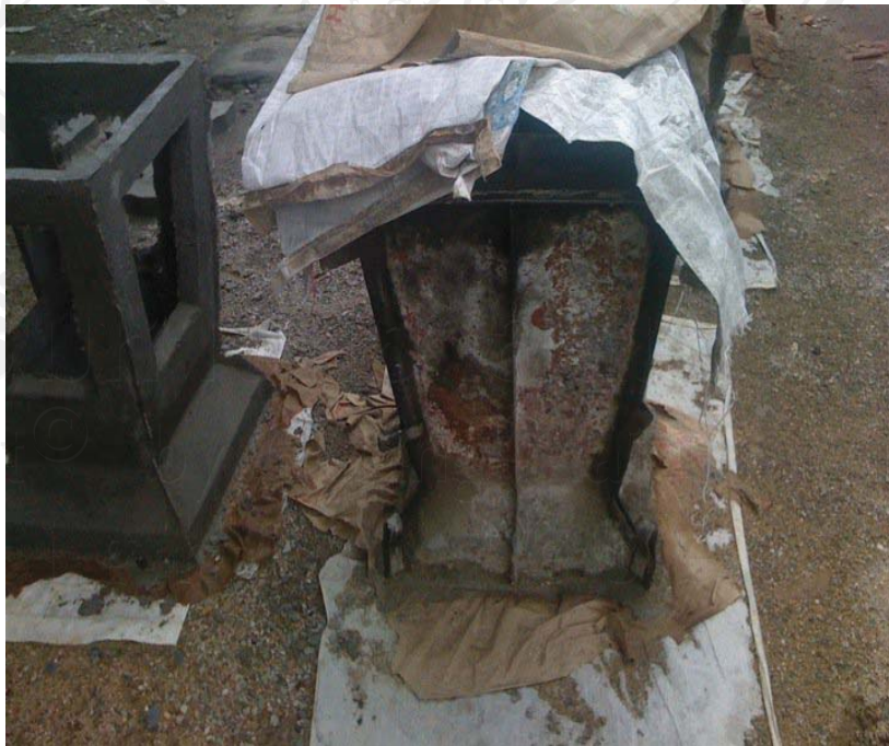
ภาพที่ 28 การนำปูนดำ,ทรายละเอียดและน้ำที่ผสมกันมาเทในแม่พิมพ์ ชั้นตอนที่ 7 หล่อในส่วนของขาโต๊ะ โดยจะต้องชุบน้ำมันก๊าดให้ทั่วแบบพิมพ์เพื่อป้องกัน การยึดติดของปูน จากนั้นผสมส่วนผสมคือ ปูนดำ ทรายละเอียดและน้ำ เทลงไปในแบบพิมพ์ขาโต๊ะที่ เตรียมไว้ รอให้แห้งสนิทแล้วจึงนำออกจากแบบพิมพ์ ดังภาพที่ 29
