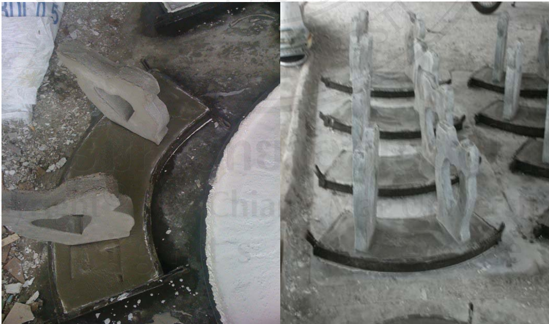
ภาพที่ 42 การเทปูนผสมทรายละเอียดและน้ำ เกลี่ยให้ทั่ว ชั้นตอนที่ 9 รอให้ปูนขาวแห้งจากนั้นนำขาเก้าอี้ที่หล่อไว้ก่อนหน้านี้มาเชื่อมต่อกับฐาน ของเก้าอี้ในขณะที่ฐานเก้าอี้ยังไม่แห้ง โดยใช้เหล็กเส้นเป็นตัวยึด ดังภาพที่ 43 และ ภาพที่ 44
