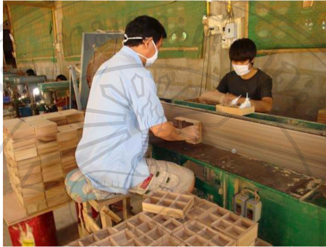
ภาพที่ 4 การนำไม้มาไสด้วยเครื่องไสใบมีด ที่มา : วิรัชญา ชุมคำ ถ่ายเมื่อวันที่ 21 สิงหาคม 2553
