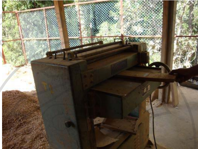
ภาพที่ 6 การนำไม้จามจรีเข้าเครื่องรีดระดับไม้ ที่มา : วิรัชฎา ขุมคำ ถ่ายเมื่อวันที่ 21 สิงหาคม 2553
