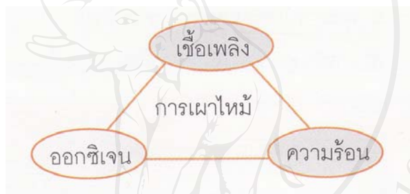
ภาพที่ 6 แสดงองค์ประกอบของหลักการเผาไหม้เชื้อเพลิง ที่มา : กองทุนเพื่อส่งเสริมการอนุรักษ์พลังงาน (2545ข)
