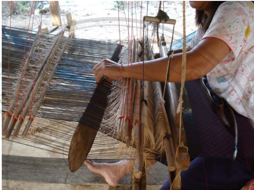
ภาพที่ 2.7 การงามไม้ราบ
