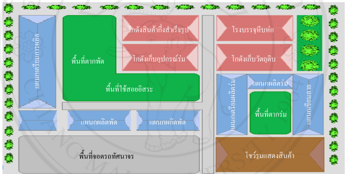
รูปที่ 4.16 แสดงแผนผังโรงงานและพื้นที่ใช้สอยของศูนย์อุตสาหกรรมทำร่มบ่อสร้าง
