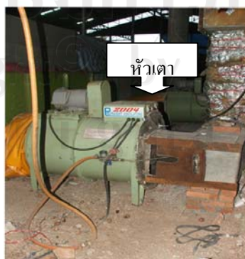
ภาพที่ เตอบลำไยที่ใช้ความร้อนจากฟืน
