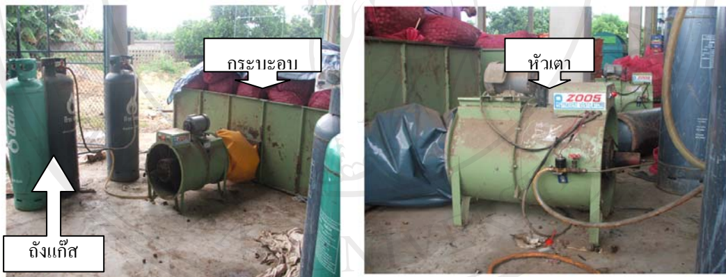
ภาพที่ 4 เตาอบลำไยที่ใช้ความร้อนจากแก๊สหุงต้ม
