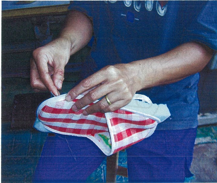
ภาพที่ 30 สอยประกอบก่อนเป็นรองเท้าสำเร็จรูป
