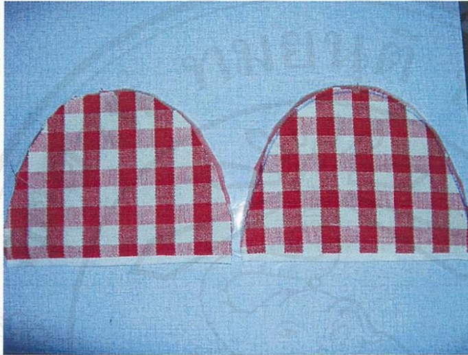
ภาพที่ 22 ผ้าฝ้ายทอมือสำหรับทำนํ้ารองเท้าที่ตัดเสร็จแล้วรอการเย็บ
