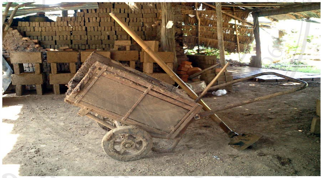
ภาพที่ 3-2 รถเข็นและจอบ ที่ใช้ในการขนย้ายดิน
