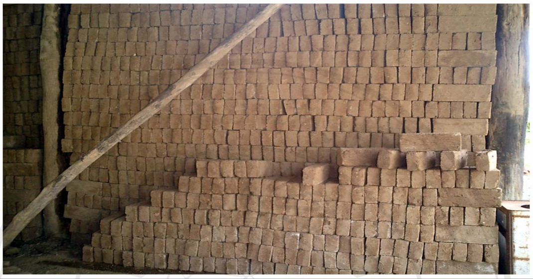
ภาพที่ 3-11 แท่งดินที่ลำเลียงเก็บไว้บริเวณเตาเผาก่อนทำการเผาต้องวางเรียงให้เป็นระเบียบ
