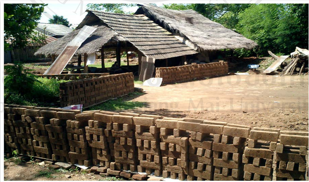
ภาพที่ 3-9 การตั้งโปรงจะตั้งเป็นกำแพงเรียงซ้อนขึ้นไป เพื่อให้ลมพัดและแสงแดดเผา
