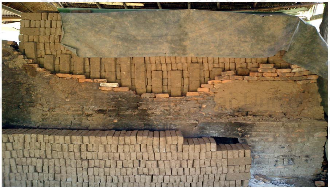
ภาพที่ 3-12 การเรียงแท่งดินเข้าเตาเผาก่อนทำการเผา
