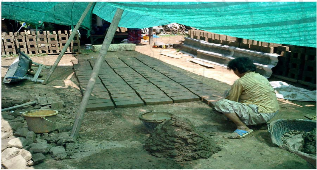
ภาพที่ 3-7 อัดดินลงไปตามช่องในแบบพิมพ์จนครบทุกช่อง หลังจากวานขี้เถ้ารองพื้นไว้แล้ว
