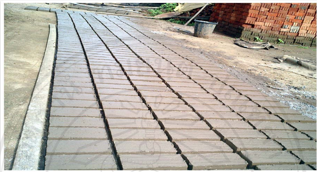
ภาพที่ 3-8 แแท่งดินบนงานตากที่เพิ่งผ่านการอัดลงแบบพิมพ์ รอเวลาให้หมาดก่อนตบให้แน่น และเรียบ
