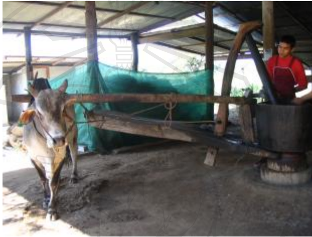
ภาพที่ 3-9 แสดงการเริ่มอัดน้ำมันงา
