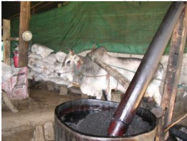
ภาพที่ 3-10 แสดงการอัดน้ำมันงา
