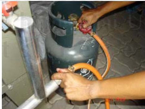
ภาพที่ 4.22 การเปิดปิดก๊าซ โดยควบคุมที่หัวปรับก๊าซแบบหัวเร่ง
