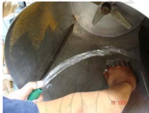
ภาพที่ 4.18 การล้างเครื่องจักรด้วยสายยางที่ไม่มีหัวฉีดปิดเปิดน้ำ
