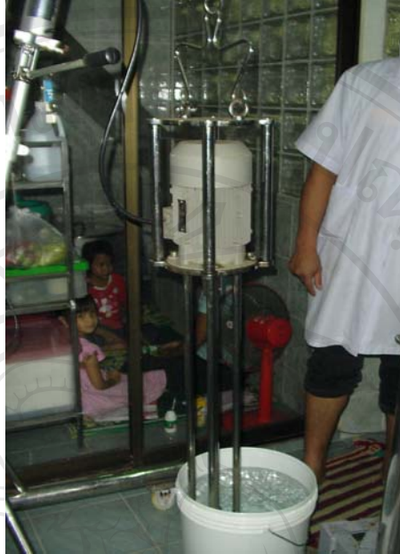
ภาพที่ 4.17 เครื่องปั่นที่ใช้ละลายเกลือแกง
