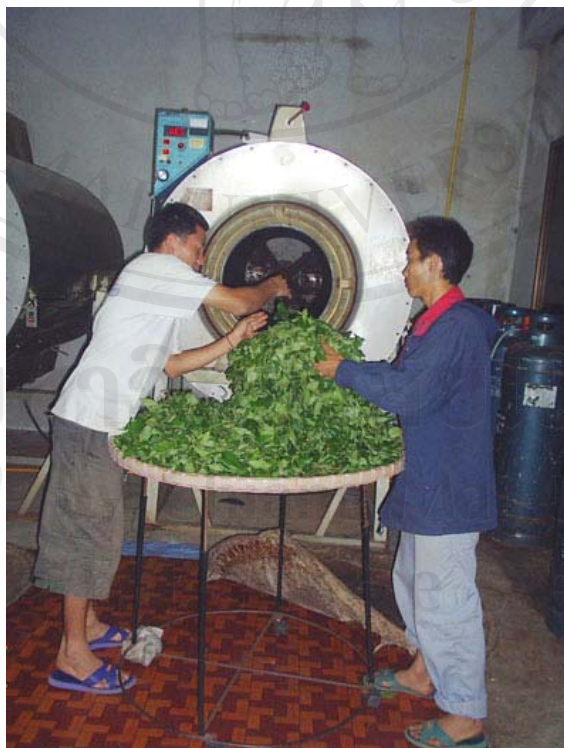
รูปภาคผนวก ก.3 เครื่องคั่วทรงกระบอกแบบหมุน (rotary panner)
