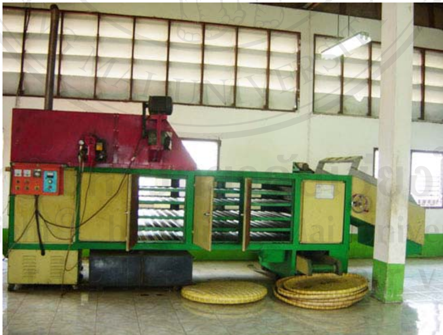
รูปภาคผนวก ก.5 เครื่องอบลมร้อน (tray drier) แบบสายพานลำเลียง
