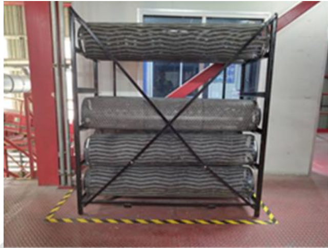
ภาพที่ 4.27 ชุดตะแกรงที่ประกอบชุด POLY INTAKE HUB และ CYLINDER SPIDER เรียบร้อยพร้อมใช้สำหรับการเปลี่ยนตะแกรง
