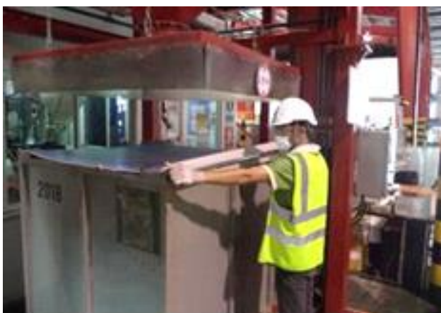
ภาพที่ 4.34 พนักงานทำการปิดฝาถังและติด pallet tag ที่ถัง
