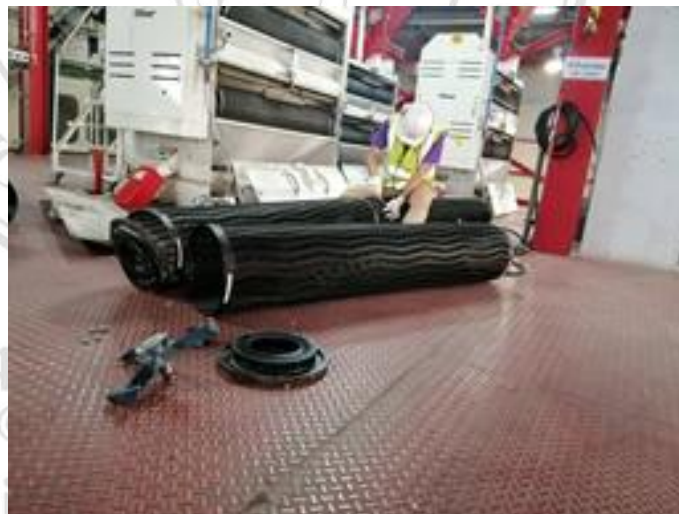
ภาพที่ 4.26 การแกะและประกอบชุด POLY INTAKE HUB และ CYLINDER SPIDER ในการเปลี่ยนตะแกรง
