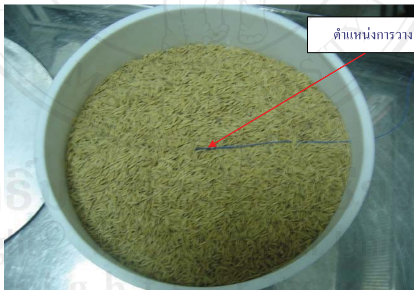
ภาพที่ 3.10 การบรรจุเมล็ดในภาชนะบรรจุในเครื่อง RF
