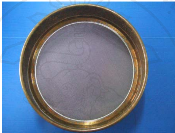
ภาพ 1 ตะแกรงที่ใช้ร่อนไข่มอคคาสุบ ขนาดช่อง 250 ไมโครเมตร
