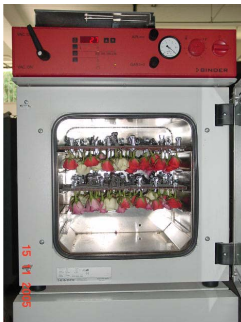
รูปที่ 3.15 ลักษณะการแขวนดอกกุหลาบภายในตู้อบระบบสุญญากาศ
