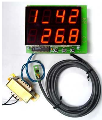
รูปที่ 3.5 บอร์ดวัดอุณหภูมิและความชื้นสัมพัทธ์ของอากาศอบแห้ง
