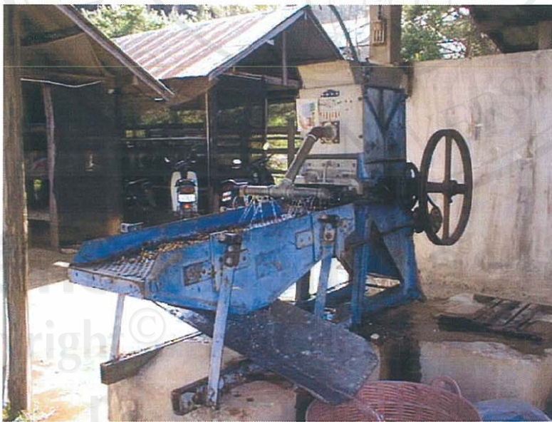
รูปที่ 3.6 การทดสอบเครื่องสีเปลือกสดแบบลูกสีทรงกระบอกแนวนอนใช้ตะแกรงโยก แยกเปลือกและเมล็ดสารกาแฟ (ศูนย์วิจัยเกษตรที่สูงขุนวาง นำเข้าจากต่างประเทศ)
