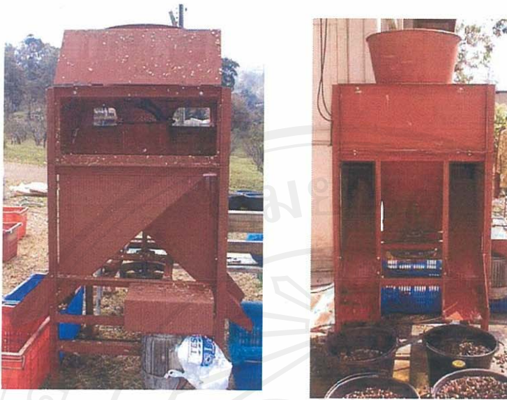
รูปที่ 3.8 เครื่องสีเปลือกสดคาเฟอราบีก้า ชนิดลูกสีทรงกรวยตัดแนวตั้ง
