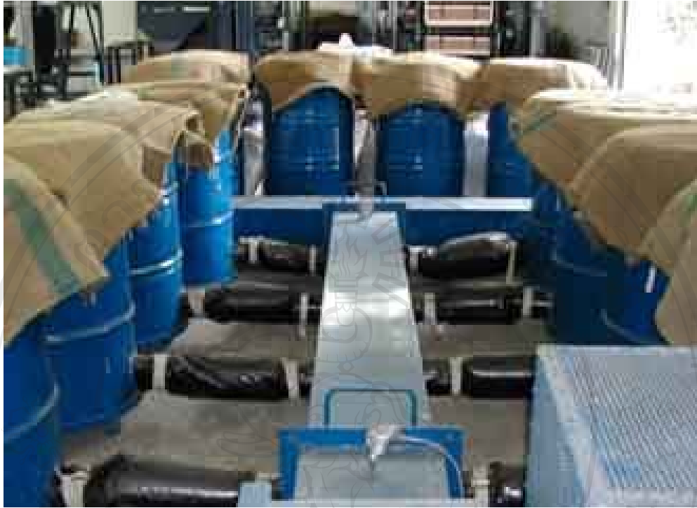
ภาพภาคผนวก 4 เครื่องอบลดความชื้นข้าวเปลือกชนิดลมร้อน
