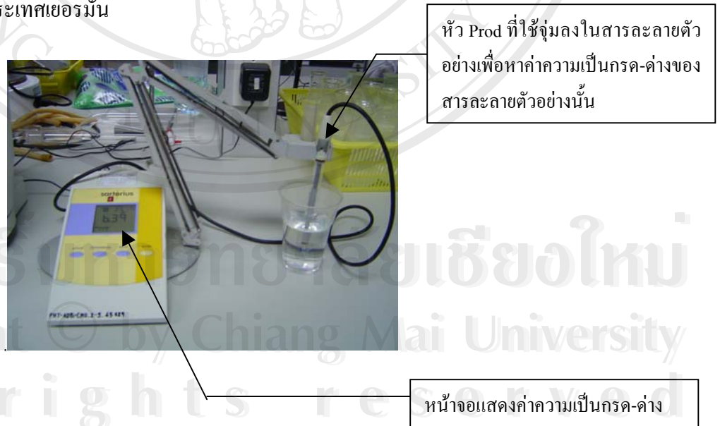
รูปที่ 2 เครื่องวัดความเป็นกรดเป็นด่าง (pH meter) รุ่น professional
