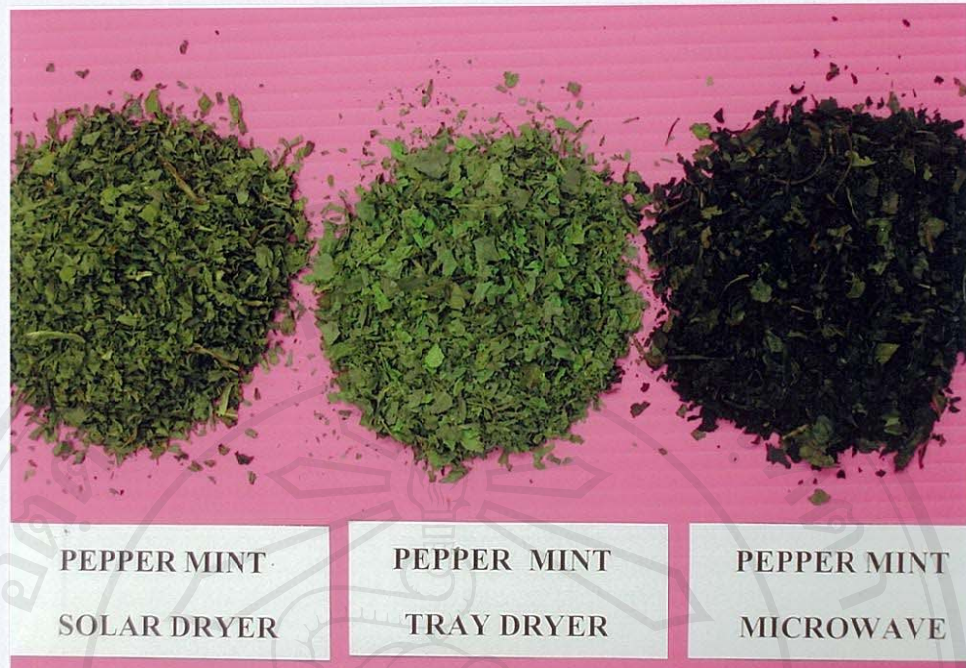
รูป ก 3. รูปเปปเปอร์มินต์หลังจากทำการอบแห้งด้วยเครื่องอบแห้งพลังงานแสงอาทิตย์ เครื่องอบแห้งไฟฟ้าแบบถาด และ เครื่องอบแห้งไมโครเวฟสุญญากาศแบบถังหมุน
