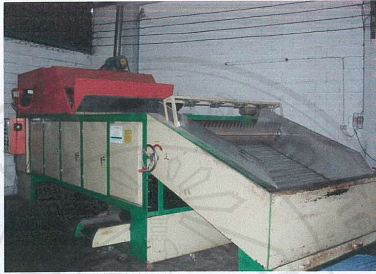
รูปที่ 2.8 เครื่องอบแห้งที่นำเข้า เป็นเครื่องอบแห้งแบบต่อเนื่อง อัตราการผลิต 100 กิโลกรัมต่อชั่วโมง ใช้ความร้อนจากการเผาไหม้น้ำมันเชื้อเพลิง (จากการสำรวจของผู้ทดลอง, 2547)
