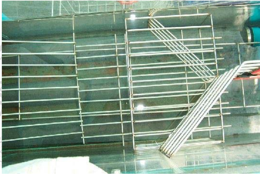
รูป 3.5 ช่องคักแยกที่ปรับเพิ่มความกว้างและเพิ่มท่อจ่ายฟองอากาศ
