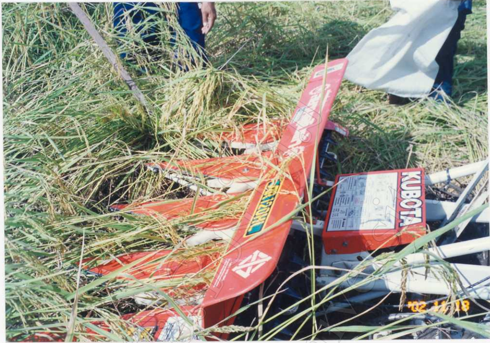
ภาพที่ 4 การเก็บเกี่ยวโดยใช้เครื่องเกี่ยวแบบวางราย
