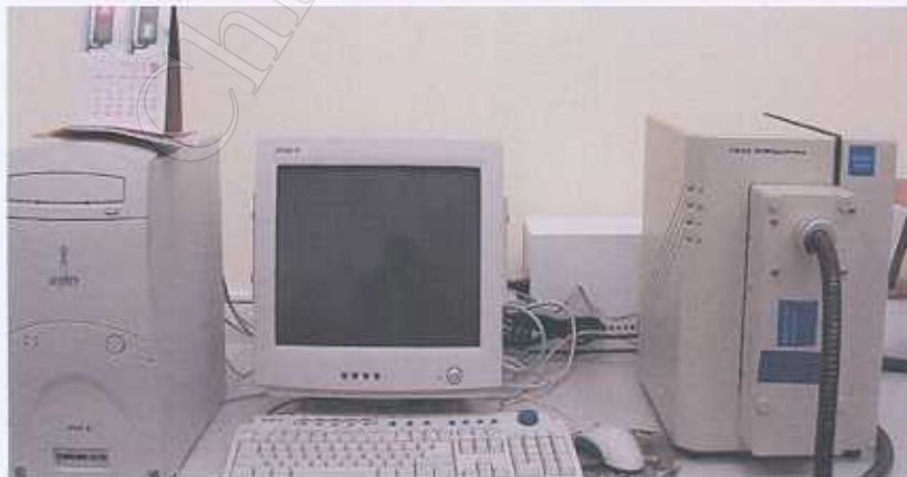
ภาพที่ 3.3 เครื่อง Near Infrared Spectroscopy (NIRS) Model NIRS FOSS 6500
