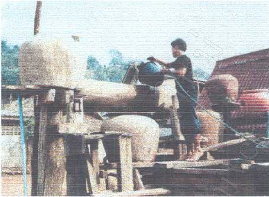
ภาพที่ 3 ตักน้ำเกลือจากบ่อเหิรรางไม้เพื่อต่อเข้าไปในบ่อพักของโรงต้มเกลือ
