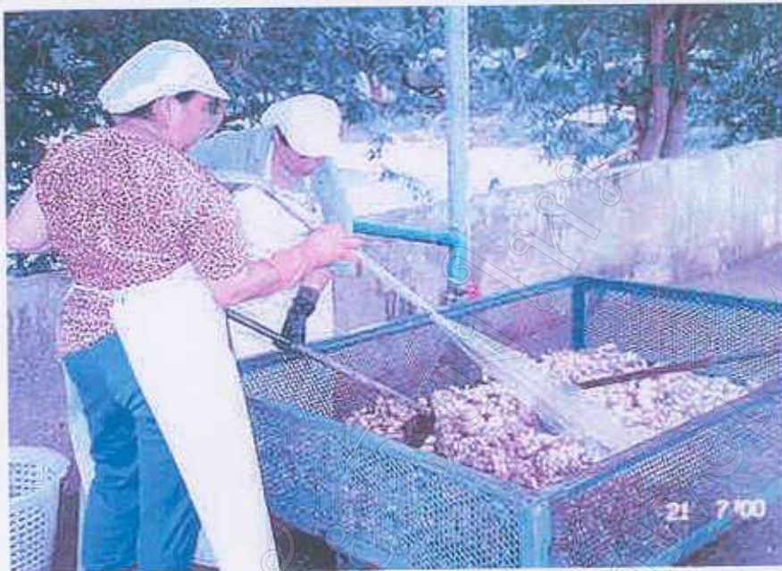
ติดตั้งหัวฉีดพร้อมวาล์วเปิดเปิดตรงปลายสายยางของน้ำใช้ส้มล้างทดสอบ
