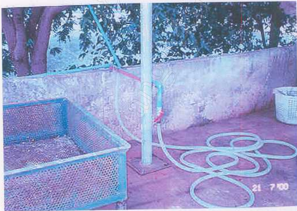
น้ำส้มล้างทดสอบเปลี่ยนสายยางเป็น 1 นิ้ว พร้อมวาล์วปิดเปิด
