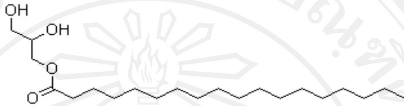
ภาพที่ 2.13 สูตรโครงสร้างของกลีเซอรอล โมโนสเตียเรต
