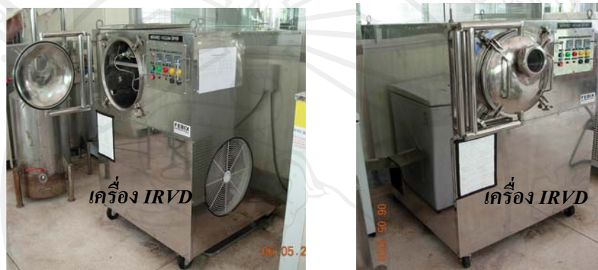
ภาพ 3.3 เครื่องอบแห้งสุญญากาศแบบอินฟราเรด (IRVD) ต้นแบบ (ภาพด้านข้าง)
