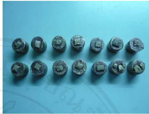
ภาพที่ จ.12 การเตรียมตัวอย่างสำหรับวิเคราะห์ ด้วยเครื่อง scanning electron microscope
