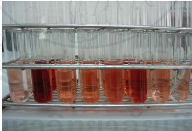
รูปที่ ง-10 ปริมาณเปอร์ออกไซด์ที่เกิดขึ้น ในการวิเคราะห์สมบัติการต้านการเกิดออกซิเดชัน โดยวิธีเฟอริกไทโอไซยานเนตในกรดลิโนเลอิกของ BHA, BHT, TBHQ, PG, แอลฟา-โทโคเฟอรอลสังเคราะห์ของ Sigma Aldrich และวิตามินอีที่สกัดจากคิสทิลเลตของน้ำมันรำข้าว ตามลำดับ
