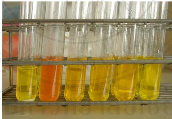
รูปที่ ง-8 การลดลงของมาลอนัลดีไฮด์ที่เกิดขึ้น ในการวิเคราะห์สมบัติการยับยั้งการเกิด มาลอนัลดีไฮด์ โดยวิธีกรดไทโอบาบิทวอลิกในกรดลิโนเลอิกของวิตามินอีที่สกัด จากคัสทิลเลตของน้ำมันรำข้าวที่ความเข้มข้น 0, 1.25, 2.50, 5.00 และ 10.00 mg/kg ตามลำดับ
