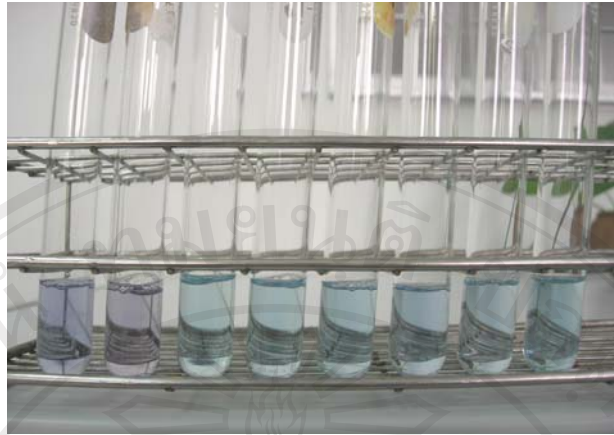
รูปที่ ง-9 ปริมาณของฟอร์มซาแซนที่เกิดขึ้นจาก NBT ในปฏิกิริยาที่มีอนุมูลอิสระซูเปอร์ออกไซด์ ในการวิเคราะห์สมบัติการจับอนุมูลอิสระซูเปอร์ออกไซด์ของ BHA, BHT, TBHQ, PG, แอลฟา-โทโคเฟอรอลสังเคราะห์ของ Sigma aldrich และวิตามินอีที่สกัดจากคิสทิลเลตของน้ำมันรำข้าว ตามลำดับ
