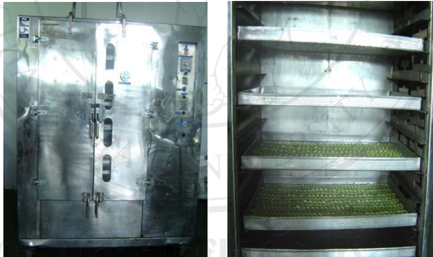
ภาพ จ-2 เตาอบลมร้อนแบบถาดที่ใช้ในการทำแห้งมะระจีน
