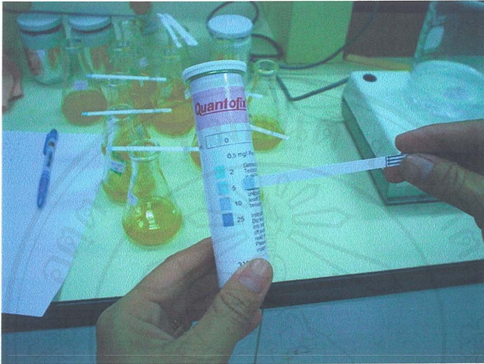
ภาพที่ ก-4 การวัดปริมาณสารไฮโดรเจนเปอร์ออกไซด์
