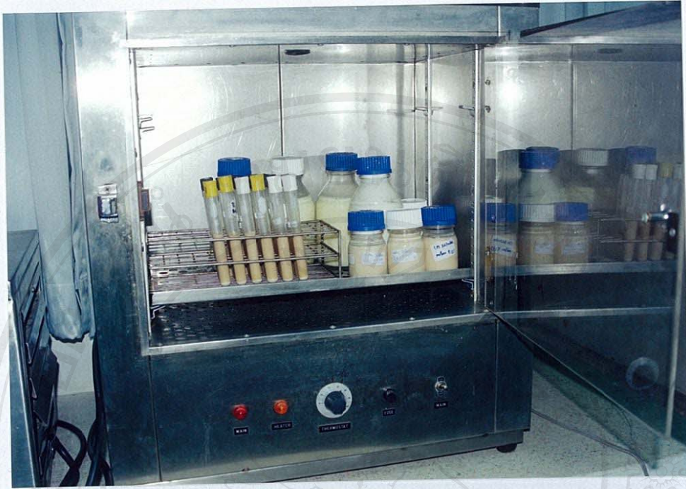
ภาพที่ ก.5 การบ่มหัวเชื้อและผลิตภัณฑ์โยเกิร์ตในตู้บ่มที่อุณหภูมิ 37 องศาเซลเซียส
