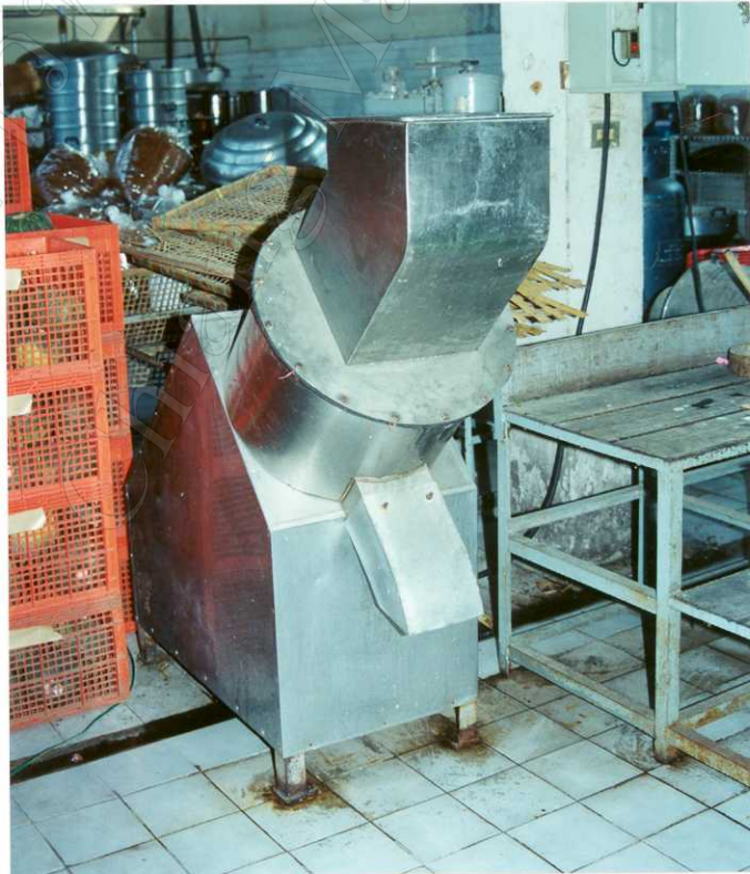
ภาพที่ ก.6 เครื่องบด (Crusher)
