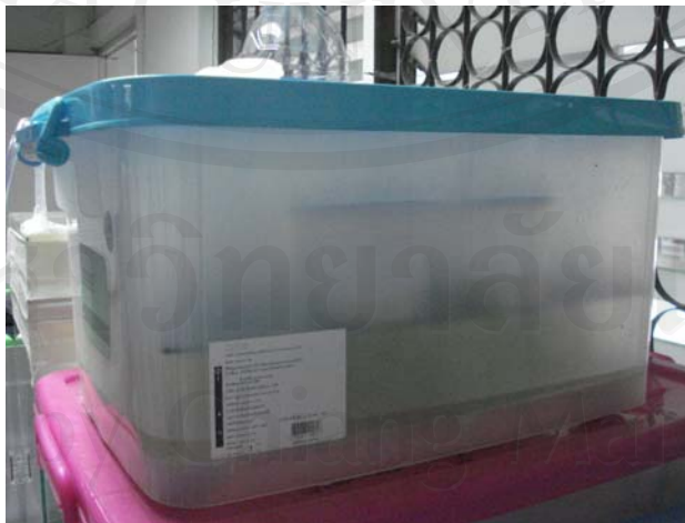
ภาพ 3.11 กล่องปรับความชื้นสัมพัทธ์ 75% ด้วยสารละลายอิมิตัวของเกลือ โซเดียมคลอไรด์ ที่ใช้ในการเลี้ยงด้วงวงข้าว
