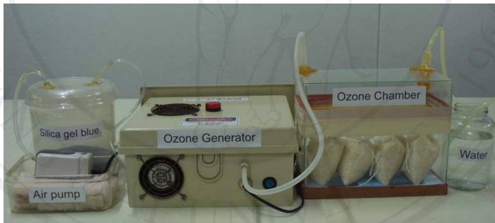
ภาพ 3.9 ภาชนะทรงสี่เหลี่ยมขนาด 12.5x25x21 เซนติเมตร ที่ใช้ในการทดสอบหาระดับความเข้มข้นและระยะเวลาที่เหมาะสมในการกำจัดด้วงงวงข้าวในข้าวสาร
