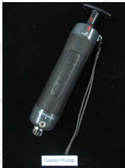
ภาพผนวก เครื่องมือวัดความเข้มข้นของโอโซน (gastec pump) (ก) และ detector tube No. 18 (ข)
