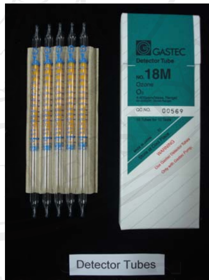
ภาพผนวก เครื่องมือวัดความเข้มข้นของโอโซน (gastec pump) (ก) และ detector tube No. 18 (ข)
