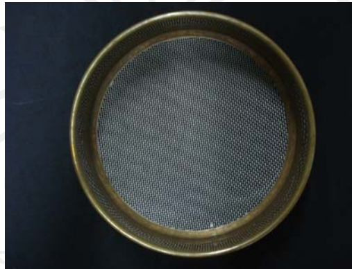
ภาพผนวก ตะแกรงที่ใช้ร่อนแยกตัวเต็มวัย ขนาดช่อง 250 ไมโครเมตร
