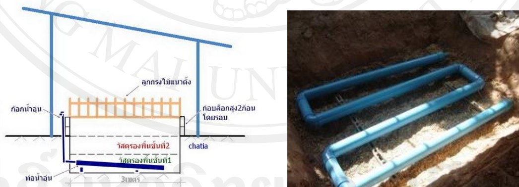
ภาพ 5 การทำระบบน้ำอุ่นจากพื้นคอกสุกรหลุม
