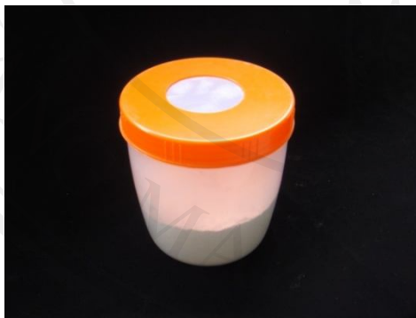
ภาพ 2 กระป๋องพลาสติกที่ภายในบรรจุแป้งสาลีผสมผงยีสต์สำหรับใช้เลี้ยงแมลง (ซ้าย) ตะแกรงขนาดช่อง 1.25 มิลลิเมตร (ขวา)
