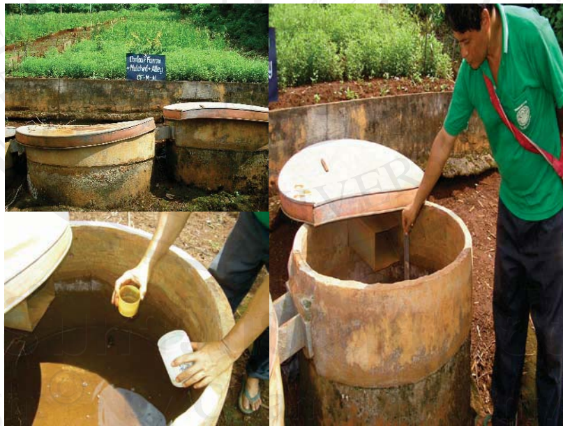
รูป 3.4 แสดงการวัดปริมาณน้ำที่ไหลบ่าบนผิวดิน (Surface Runoff) ในถังดักตะกอน
