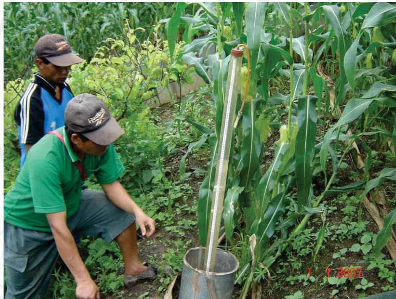
รูป 3.3 แสดงการวัดอัตราการซึมน้ำเข้าสู่ผิวดิน (Infiltration Rate, IR) โดยใช้เครื่องมือสำเร็จรูป งานวัดการซึมน้ำของดิน(Disc Permeameter)
