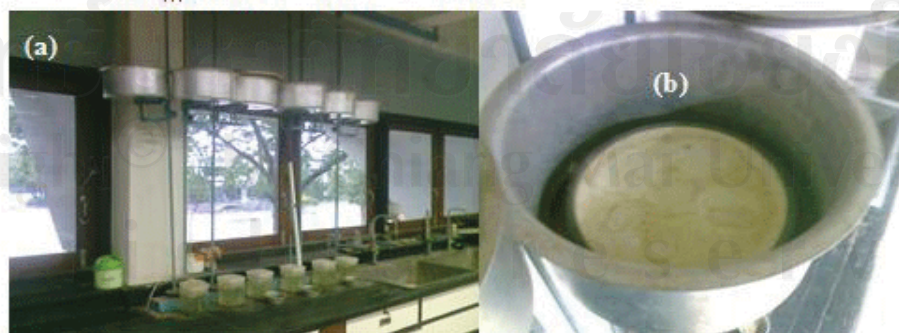
รูปที่ 3.12 (a) อุปกรณ์ที่ประกอบเป็น Hanging column ที่มีระดับแรงดึงน้ำสูง 100 ซม. (b) แผ่น วัสดุพรุนที่นำกระบอกโลหะในข้อ (i) มาวางเพื่อปรับแรงดึงน้ำในดินปรับระดับสมดุลกับ ความสูงของน้ำ 100 ซม.
