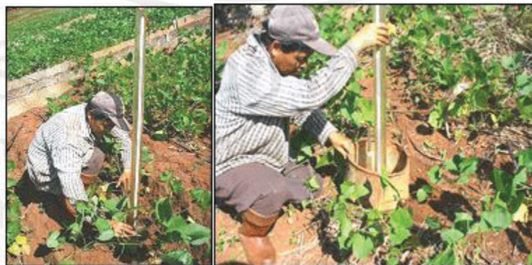
รูปที่ 3.13 แสดงการวัดอัตราการซึมน้ำเข้าสู่ผิวดิน (Infiltration rate, IR) โดยใช้เครื่องมือสำเร็จรูปจานวัดการซึมน้ำของดิน(Disc permeameter)
