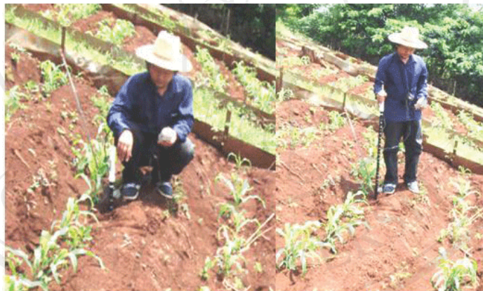
รูปที่ 3.14 แสดงการวัดปริมาณการกักเก็บน้ำภายในดินโดยใช้เครื่องมือวัดความชื้น Time domain reflectometry (TDR)
