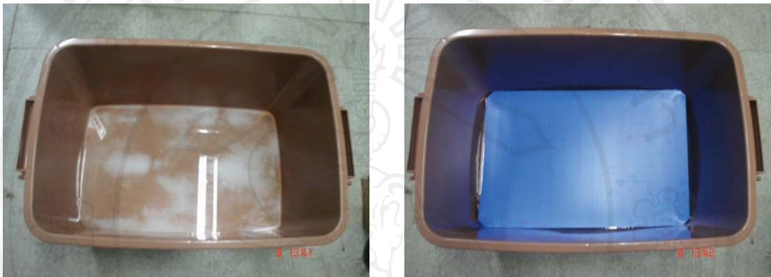
ภาพ 3.2 กล่องควบคุมความชื้นสัมพัทธ์ 75 เปอร์เซ็นต์
